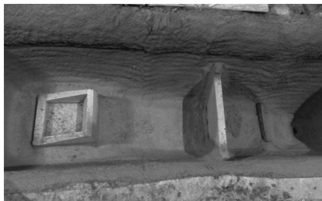
Рис. 6. Промежуточный ковш с установленными в него элементами системы УФС
