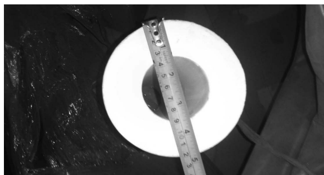
Рис. 2. Кварцевый погружной стакан перед разливкой на МНЛЗ
