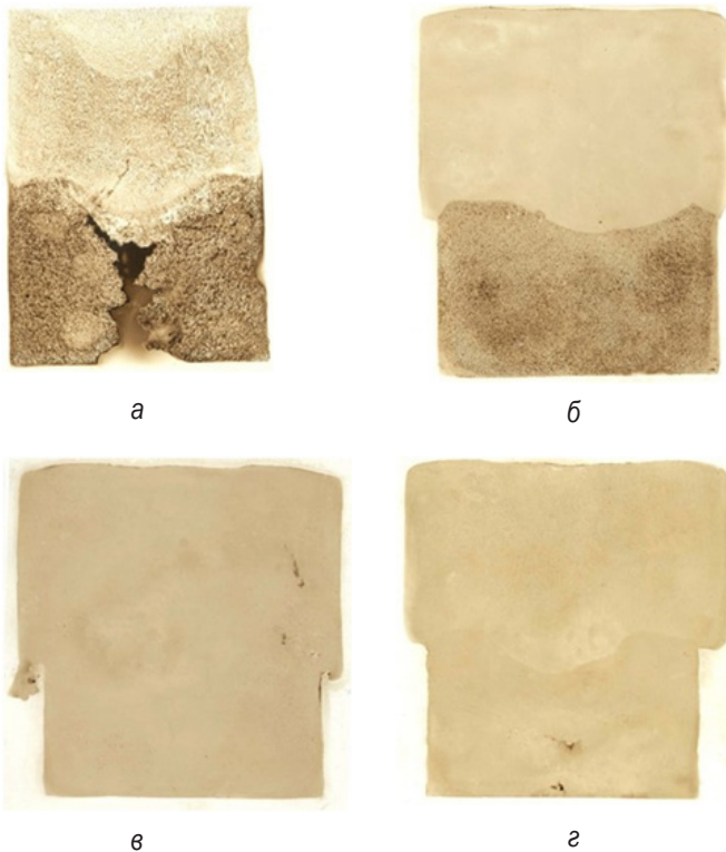
Рис. 2. Сірчані відбитки макрошліфів: а — на сталь 20 наплавлене сталь 20; б — на сталь 20 наплавлене сталь 12Х13; в — на сталь 12Х13 наплавлене сталь 12Х13; г — на сталь 12Х13 наплавлене сталь 20
