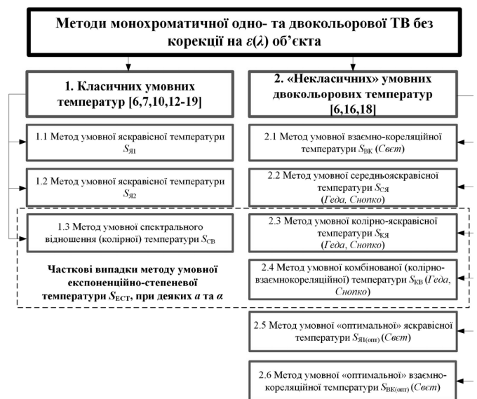
Рис. Класифікація методів монохроматичної одно- та двокольорової ТВ, які не враховують інформацію про \varepsilon(\lambda) об'єкта
