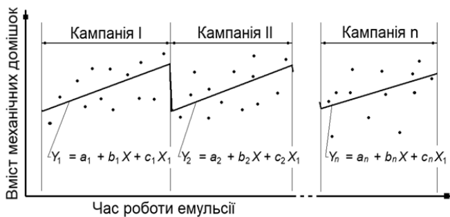
Рис. 2. Методика отримання регресійних рівнянь для кожної кампанії роботи емульсії
