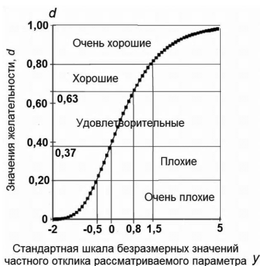
Рис. 2. Общий вид функции Харрингтона с нанесенными интервалами стандартных значений частного отклика по шкале желательности
