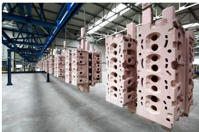
Рис. 4. Конвеєр з модельними блоками, блок включає 4 моделі окремих виливків [11]
