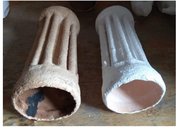
Рис. 6. Керамічні форми після низько- та високотемпературного випалювання
