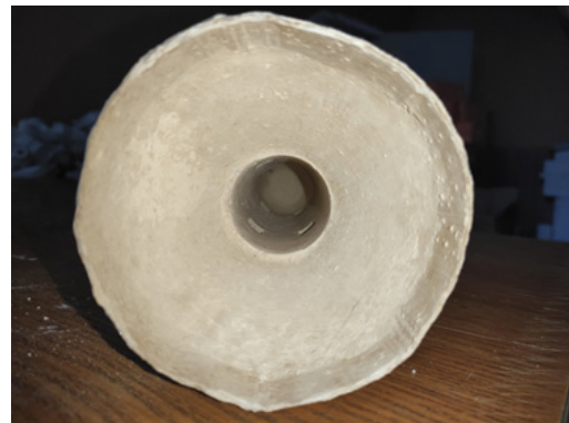
Рис. 5. Внутрішня поверхня керамічної форми після низькотемпературного (а) та високотемпературного (б) випалювання
