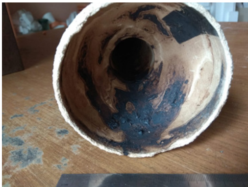
Рис. 5. Внутрішня поверхня керамічної форми після низькотемпературного (а) та високотемпературного (б) випалювання
