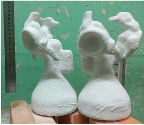
Рис. 4. Керамічні форми, що виготовлені за пластиковими моделями ендопротезів
