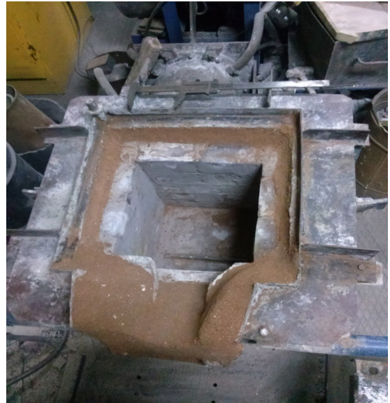
Рис. 4. Зовнішній вигляд плавильного тигля ємністю 120 кг для проведення ЕШТП стружки
